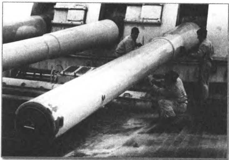
Башня «Антон». Матросы моют опущенные вниз стволы. Кожаные манжеты, закрывающие амбразуры орудий от заливания морской водой, сняты
